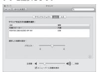
3)「サウンドを出力する装置の選択」リストから「FOSTEX USB AUDIO HP-A4」を選択します。
