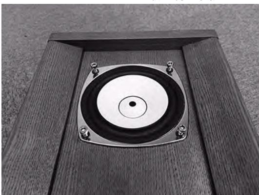
フレームとパッキンを合わせた状態で、スピーカーボックスのバッフル穴にスピーカーユニットを入れます。この時、フレームの取付穴とスピーカーボックスのネジ穴を合わせてください。
