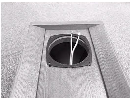
スピーカーユニットに付属しているパッキンをスピーカーボックスの上に置きます。パッキンは、スピーカーボックスとスピーカーユニットを密着させ気密性を保つために必要です。パッキンを使用しないと、隙間から空気が漏れてスピーカーボックス本来の性能を発揮することが出来ませんので、必ず装着してください。
