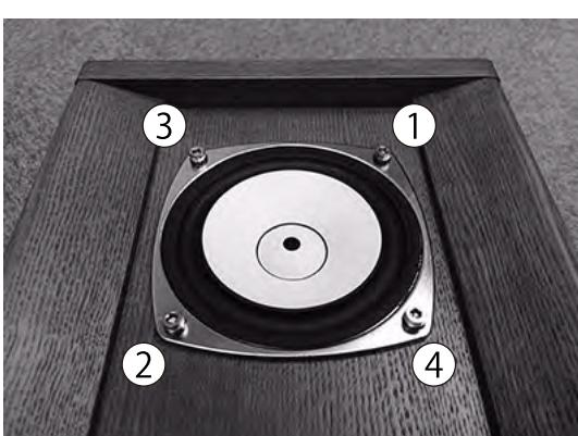
次に、Lレンチで写真の順番どおりに対角に締めていき、最後に一番目に締めたキャップボルトを締めると、均一に固定することができます。
