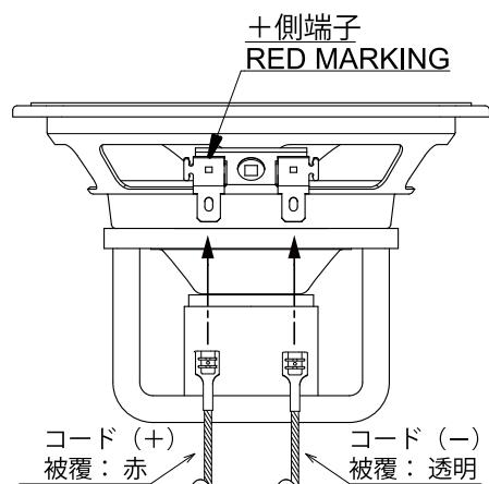
内部配線コードの端子をスピーカーユニットの端子に接続します。
