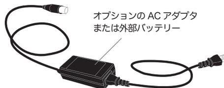
**<注意>**：[DC IN]コネクタの定格電圧はDC10～24Vです。[DC IN]コネクタに外部バッテリーを接続する場合は、必ず定格で十分な電圧を保有したバッテリーをご使用ください。なお、[DC IN]コネクタのピン・アサインについては、「各部の名称と機能」の12ページを参照してください。
