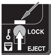
**<メモ>**：電池ボックスを取り出すには、[EJECT/LOCK]レバーを下（EJECT側）へスライドしてロックを解除します。ロックが解除されると電池ボックスが前面に数ミリ出てきて、手で引き抜くことができます。
