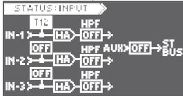
また、インプット1にT12の電源を供給し、インプット2と3にP48の電源を供給した場合は、下記例の表示になります。
