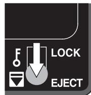
**<注意>**：電池ボックスの取り出しは、必ず電源をオフにしてから行うか、[POWER]スイッチが“EXT”ポジションの状態で行ってください。
