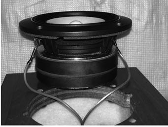
内部配線コードの端子をスピーカーユニットの端子に接続します。接続は、極性を間違えないよう右図を参照してください。コードを接続する時は、スピーカーボックスの上にタオルなどを敷き、スピーカーユニットをその上に置くと、スピーカーボックスを傷付けずに安全に作業を行うことができます。
