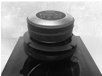
スピーカーユニットに付属しているパッキンをスピーカーユニットの磁気回路側から通して入れます。パッキンは、スピーカーボックスとスピーカーユニットを密着させ機密性を保つために必要です。パッキンを使用しないと、隙間から空気が漏れてスピーカーボックス本来の性能を発揮することが出来ませんので、必ず装着してください。
