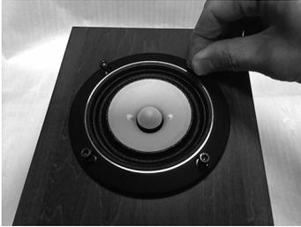
フレームとパッキンを合わせた状態で、スピーカーボックスのバッフル穴にスピーカーユニットを入れます。この時、フレームの取り付け穴とスピーカーボックスのネジ穴を合わせてください。
