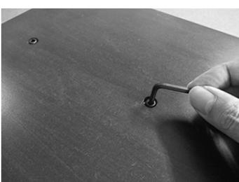
次に、Lレンチで締めて固定します。一箇所を一度に強く締めず均等に締め付け、固定するようにしてください。
