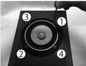
次に、Lレンチで写真の順番通りに対角に締めていき、最後に一番目に締めたネジを締めると、均一に固定することができます。
