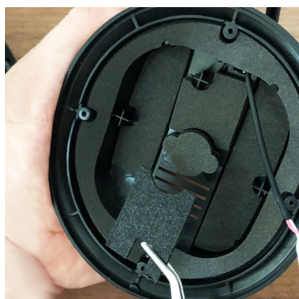
方式を選択するハウジング用チューニングシートの選択・取り付け、RP ドライバーユニットのはんだ付け
