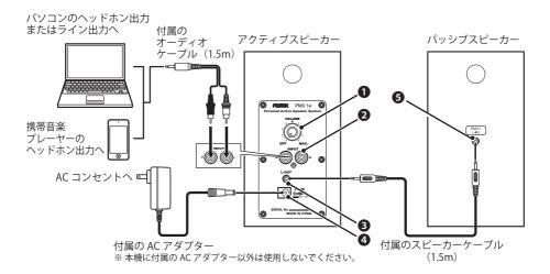
アクティブスピーカー(R チャンネル) ステレオパワーアンプを搭載しており、 入力信号の右チャンネルを再生します。
